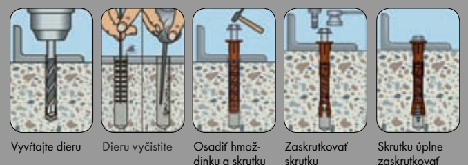
Vyvrátajte dieru Dieru vyčistíte Osadíte hmoždinku a skrutku Zaskrutkovať skrutku Skrutku úplne zaskrutkovať
