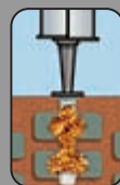
Zmiešavací hrot zasunúť do sitka až na dno a sitko plynulým vyťahovaním rúrky vyplníť hmotou.
