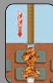
Kotviacu tyč/závitové puzdro pomaly otáčavým pohybom zasunúť do hmoty a vyčakať, pokiaľ nevytvrdne.
