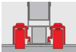
Trojuholníkový držiak u priečne položených základových lišt pomocou krížových listových spojok.
